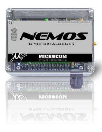
El Nemos es un registrador de datos o "datalogger" con comunicación GSM/GPRS y alimentación a pilas.
